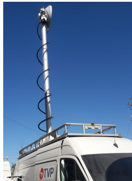
Furgoneta TVP con mástil de transmisión y antena
