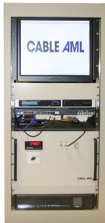
Estación transmisora DVB-C
